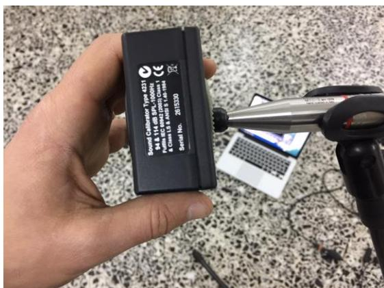
Figura 4 - Calibrazione della catena di misura tramite calibratore Brüel & Kjaer.
