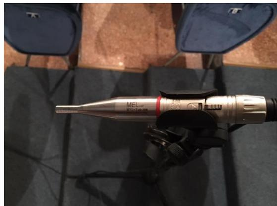
Figura 2 - Microfono da misura Mellab MY-c3.
